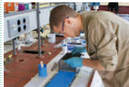
Ein Lehrling trägt Strassenmarkierfarbe auf ein Prüfblech auf.
