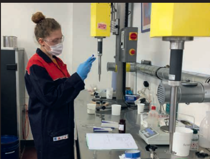
Lara Hermann der Sun Chemical AG prüft die Lösungsmittelbeständigkeit einer UV-Beschichtung.
